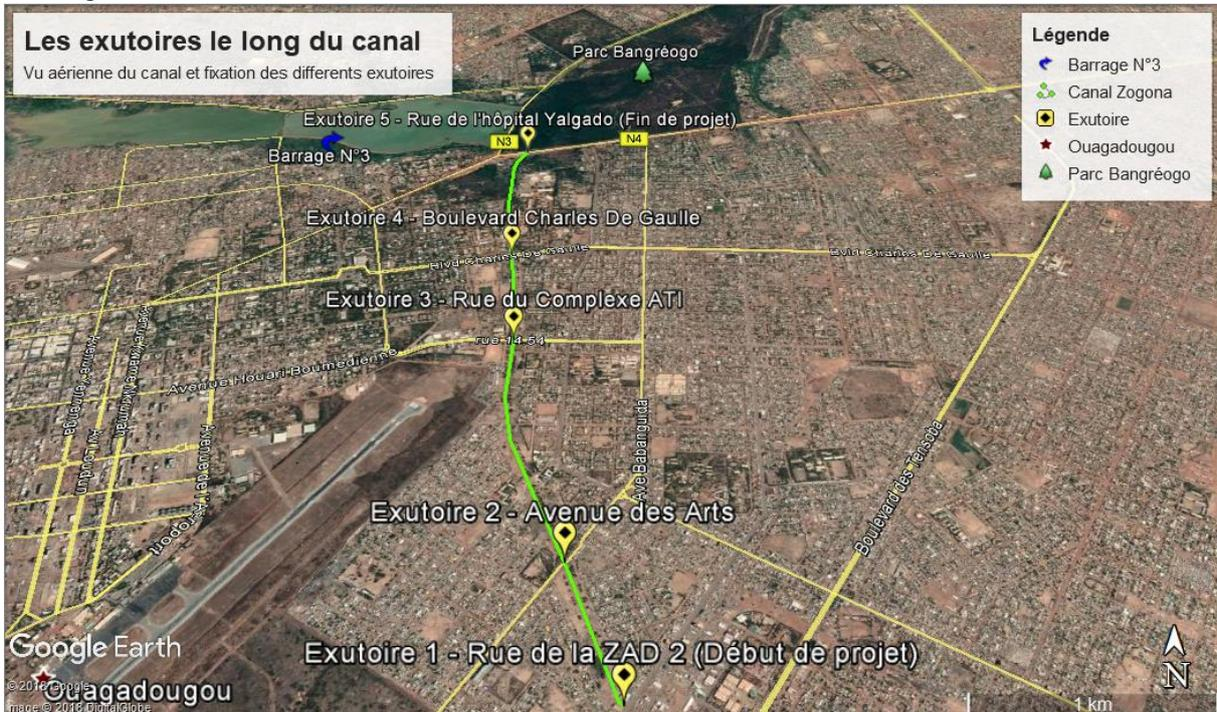
Photo 11: Les exutoires par section le long du canal de Zogona
