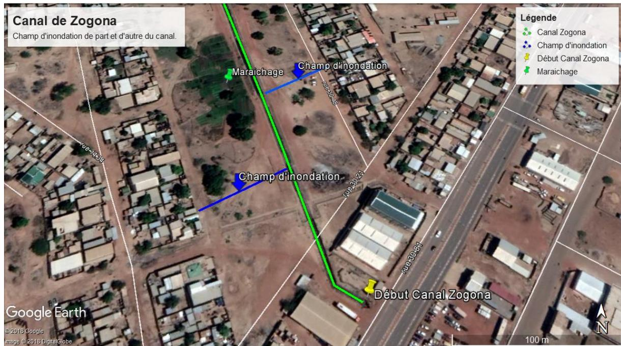
Photo 5: Champs d'inondation de 60 [m] de part et d'autre du canal.
