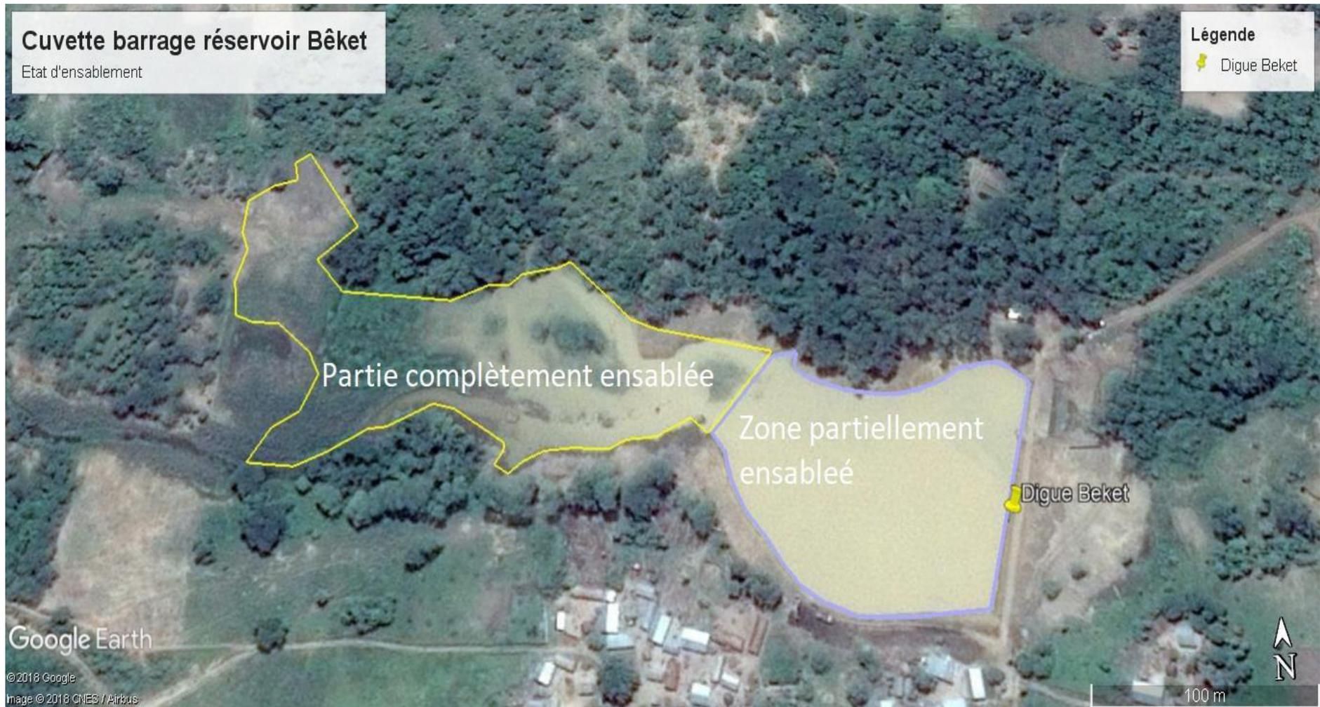
**Figure 18 :** Configuration de l'ensablement de la cuvette
