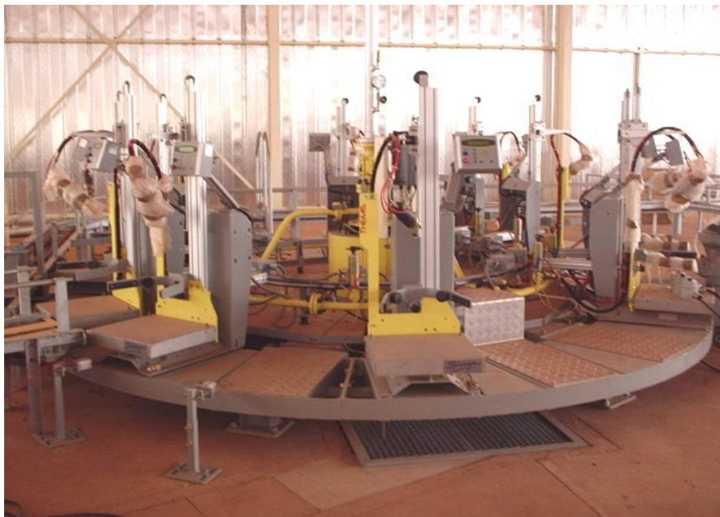
Carrousel d'emplissage des bouteilles de gaz (nouveau centre emplisseur)
