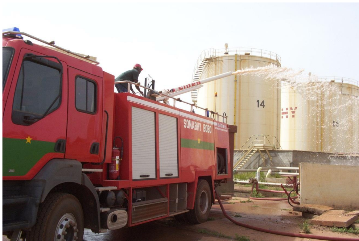
Camion de lutte contre l'incendie (fourgon mousse grande puissance)
