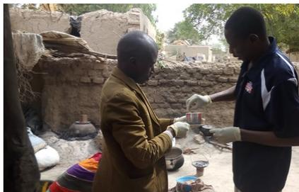
*Photo1: Contrôle du chlore résiduel dans un échantillon d'eau dans le village de Kouan à Macina*
