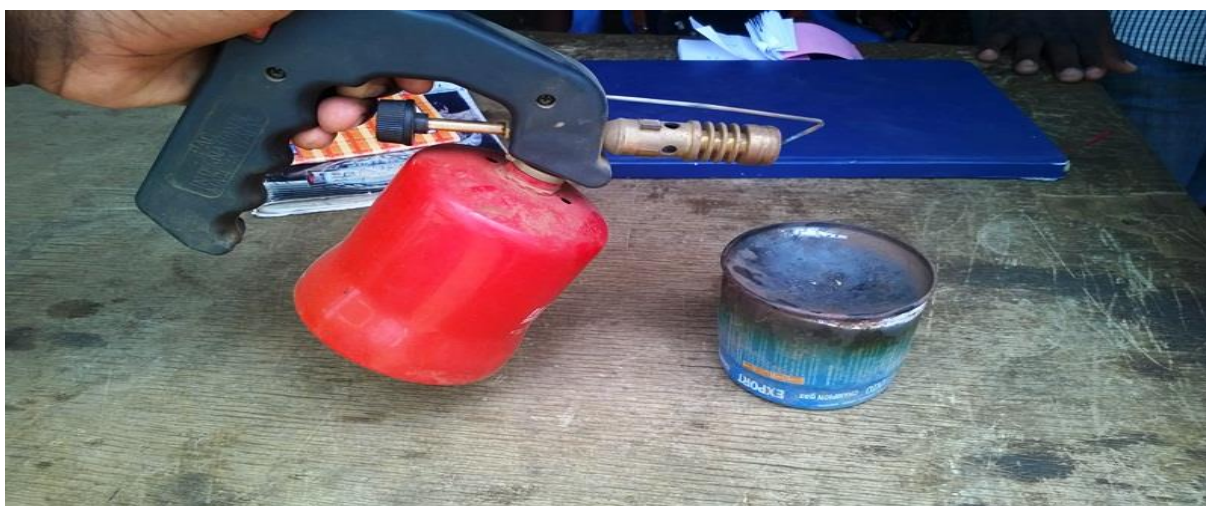
Figure 16: Chalumeau et lieu de brulage de l'amalgame
