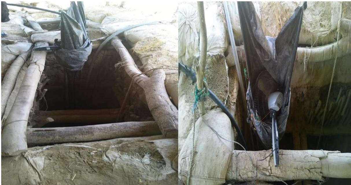
Figure 11: Système de ventilation des puits
