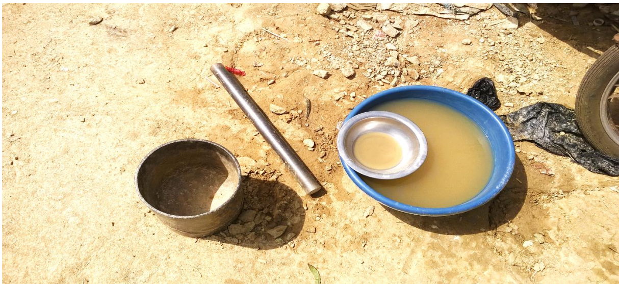
Figure 9: Mortier et pilon pour la réalisation des tests de teneur
