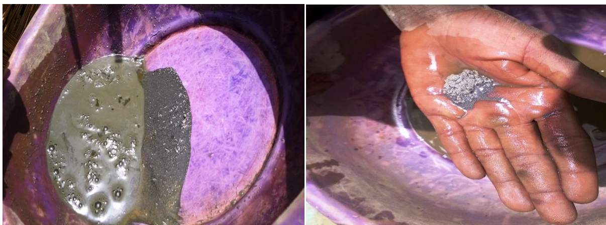
Figure 15: Résultat du processus de l'amalgamation
