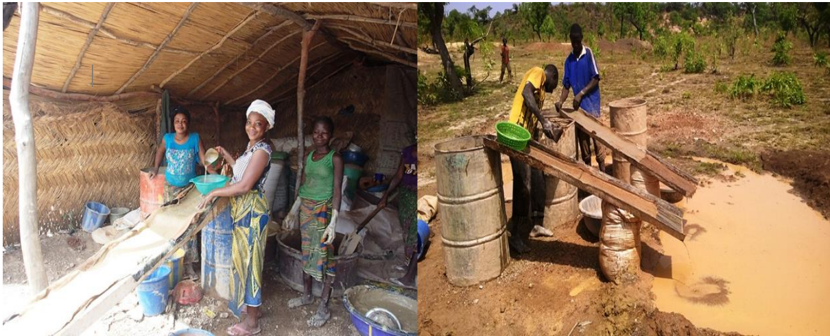
Figure 14: Opération de lavage des boues de minerai sur un sluice
