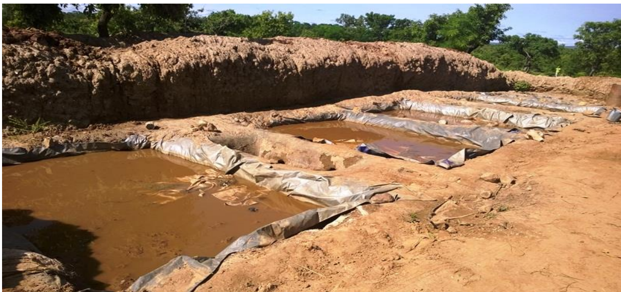
Figure 23: Configuration d'un site de cyanuration
