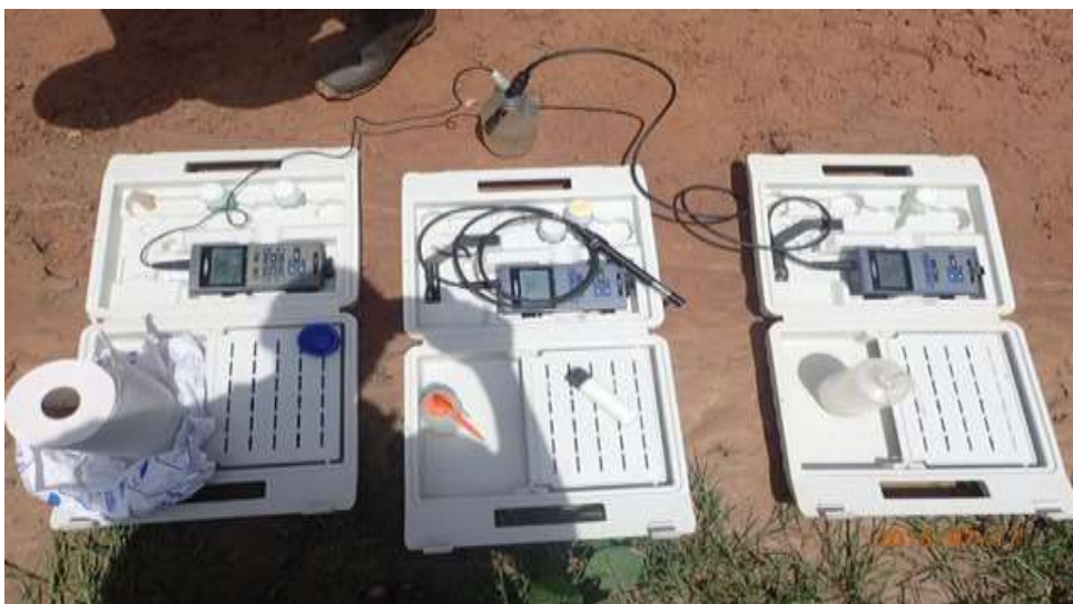
Figure 19 : Séance de mesure des paramètres d'un échantillon d'eau
