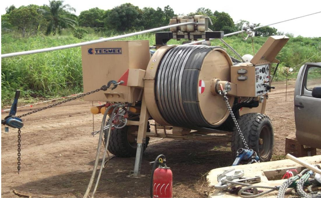
**Figure V.4** : Représentation d'une machine TESMEC (Treuil/Freineuse) en mode freineuse
