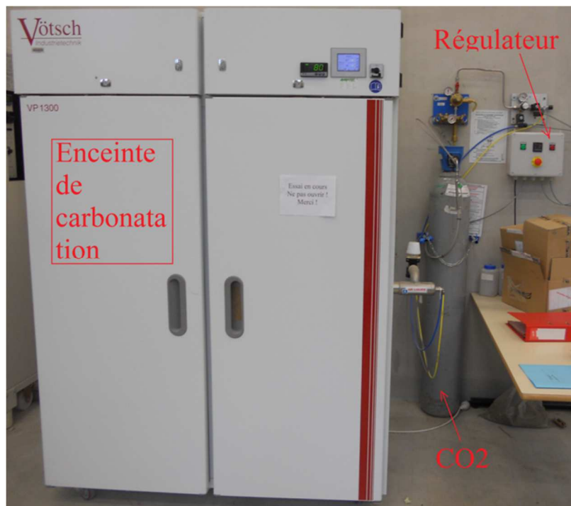
Figure 2-23. Dispositif de carbonatation accélérée avec l'enceinte climatique VötschVP 1300.
