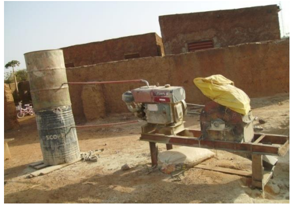
Photo N° 7 : Machines de mouture de minerai en poudre très fine
