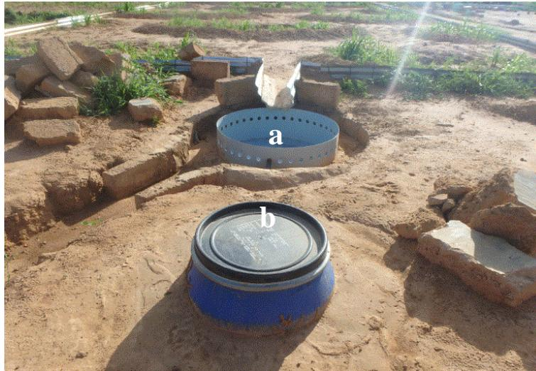
Figure 2-11: Dispositif de mesure de la lame d'eau ruisselée: (a) partiteur, (b) fût de 250 litres. Photo : Zouré Cheick Oumar
