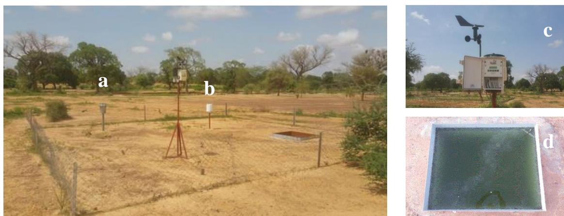
*Figure 2-10: Dispositif de mesure des précipitations et des paramètres météorologiques
