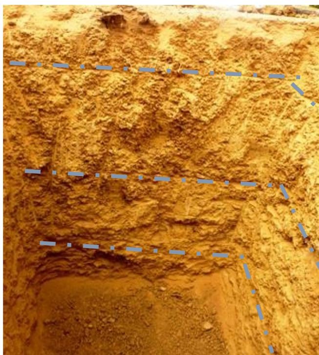
Figure 2-6: Ouverture de fosse pédologique avec illustration des différents profils
