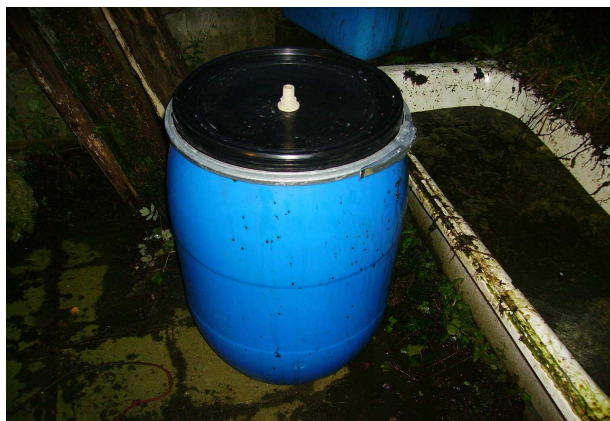
Figure 8: Exemple de digesteur batch [1]
