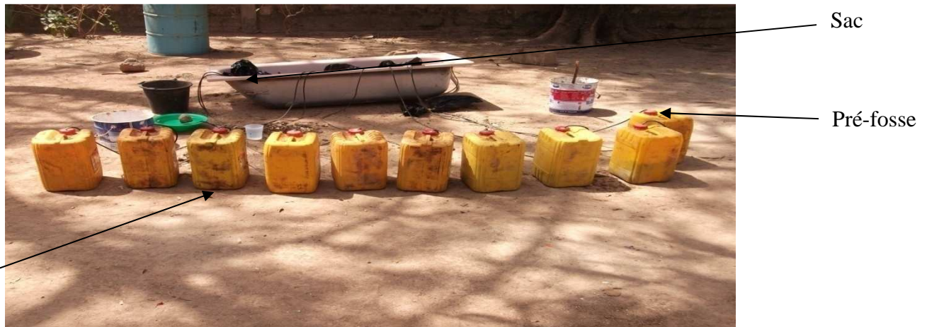
Figure 6: Digesteurs exposés au soleil
