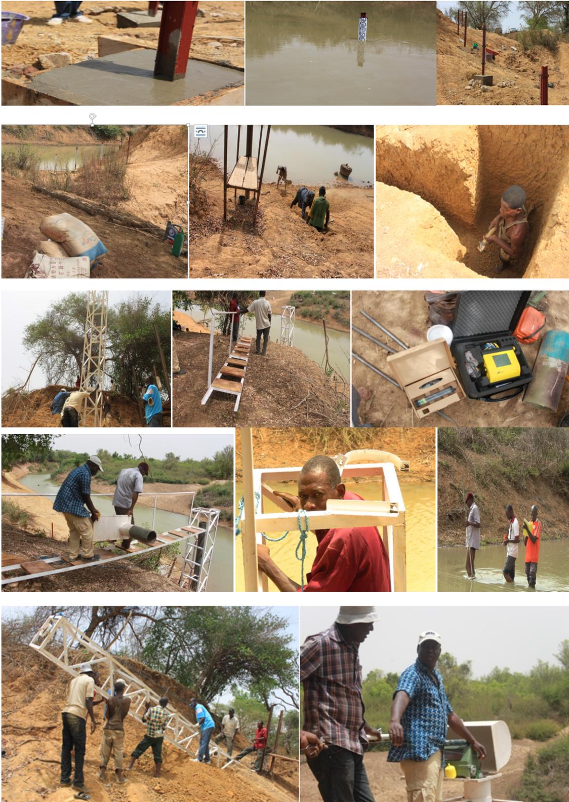
Annexe III- 3 : Jaugeages de contrôle des débits à l'ADCP sur le Mouhoun à Nwokuy
