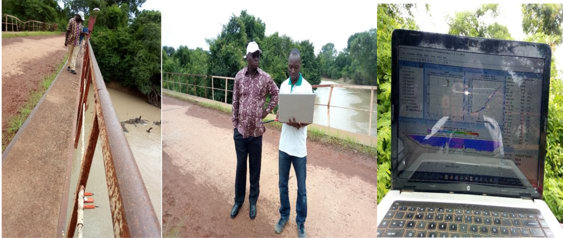
Annexe III- 4 : Jaugeages de contrôle des débits à l'ADCP sur le Mouhoun à Tourouba
