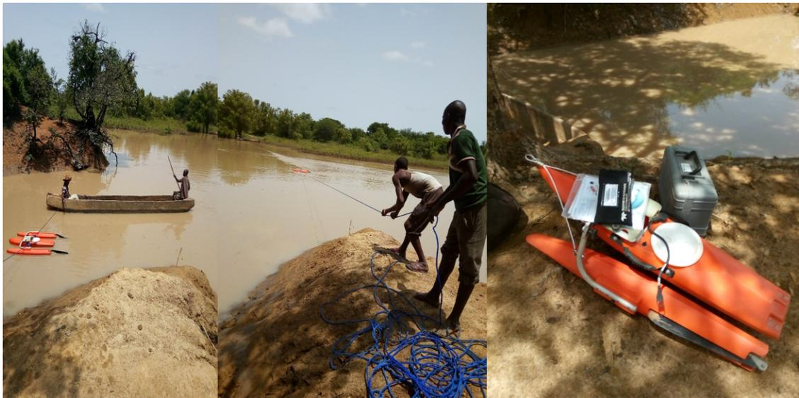
Annexe III- 5 : Jaugeages de contrôle des débits à l'ADCP sur le Sourou à Lery
