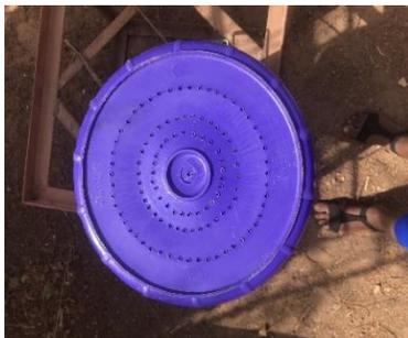
**Figure 7:** Perforation des pilotes
