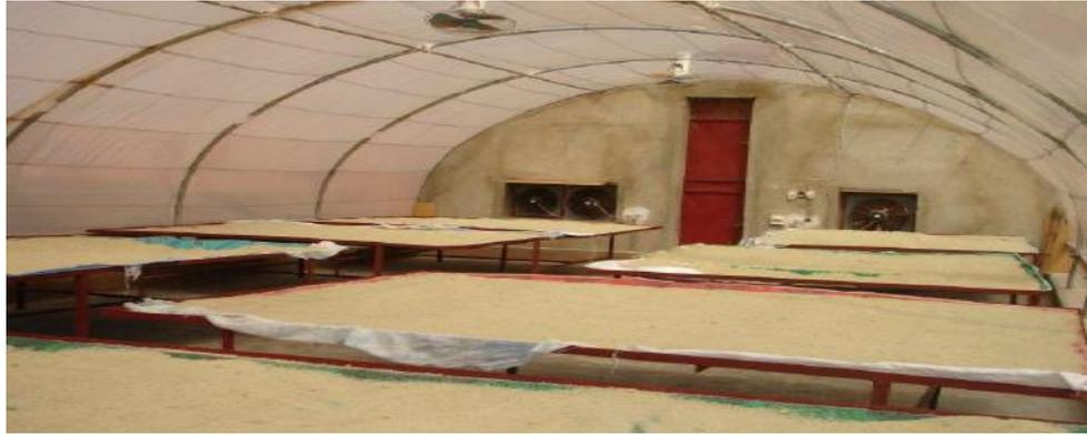
Figure 11: Vue intérieure du séchoir solaire Serre [5]
