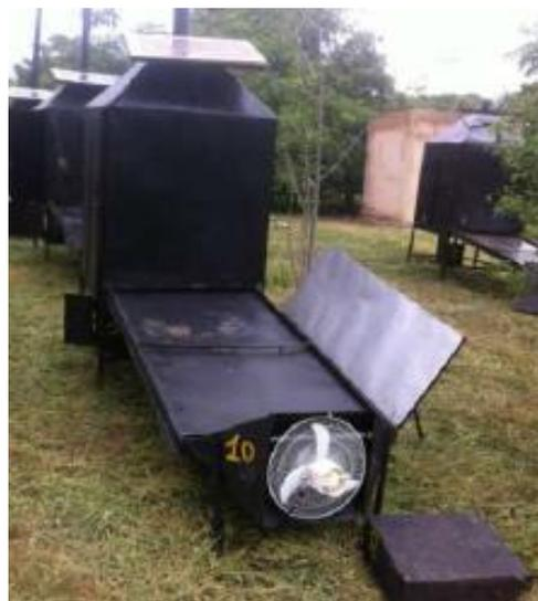
Figure 9: Séchoir hybride solaire/gaz muni d'un réflecteur et d'un ventilateur [3]
