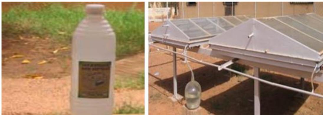
Eau distillée conditionnée en bidon et distillateurs
