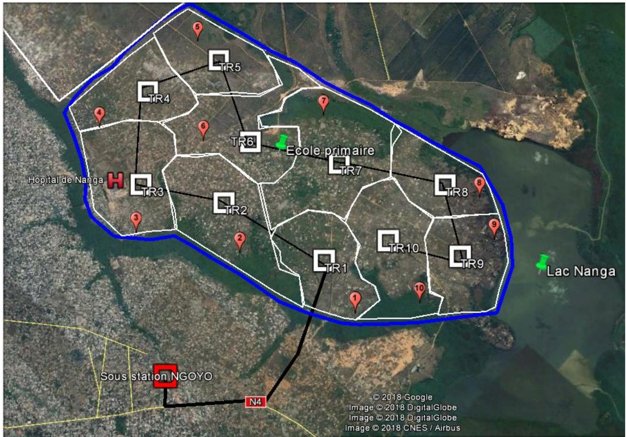
Figure 27: Emplacement des postes de distribution dans Nanga
