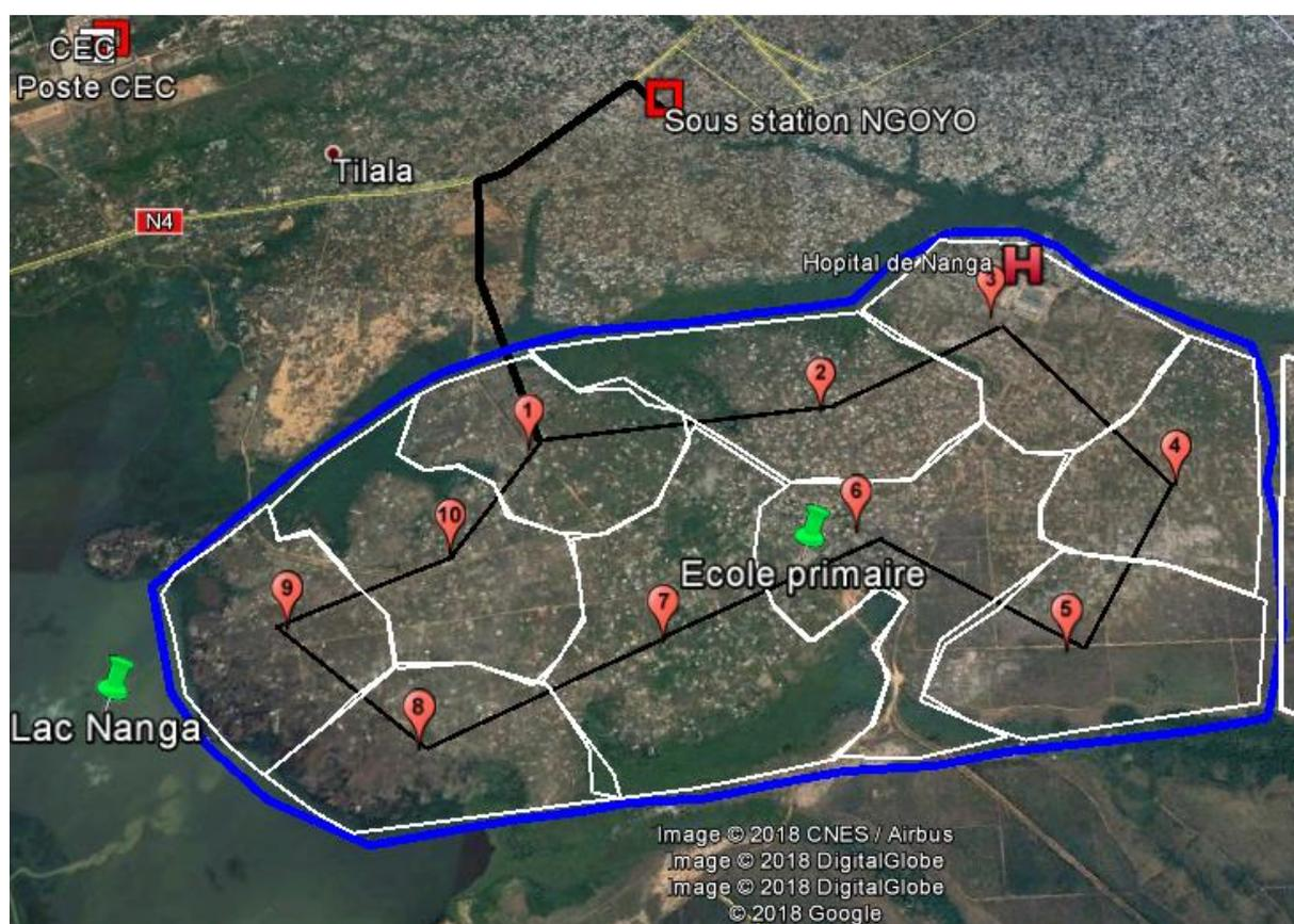
Figure 19: Points d'implantation des transformateurs
