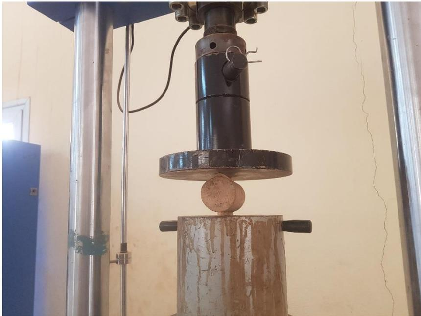
Photo 4: Dispositif de l'essai de traction par fendage
