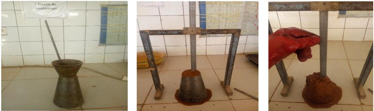
*Figure 4: Mesure de l'affaissement au mini cône*
