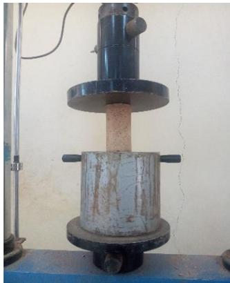
Figure 5: Compression sur un échantillon
