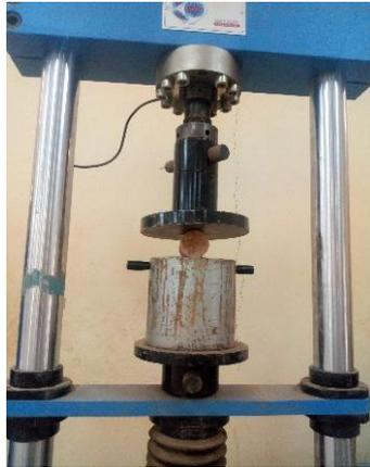
Figure 6: Traction par fendage d'un échantillon
