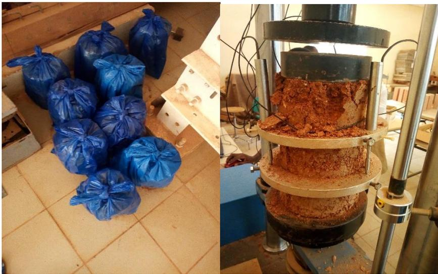
Figure 26: photos de quelques éprouvettes pour l'essai de compression
