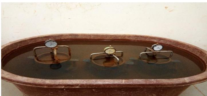
Figure 19: Moule en immersion pour l'essai CBR
