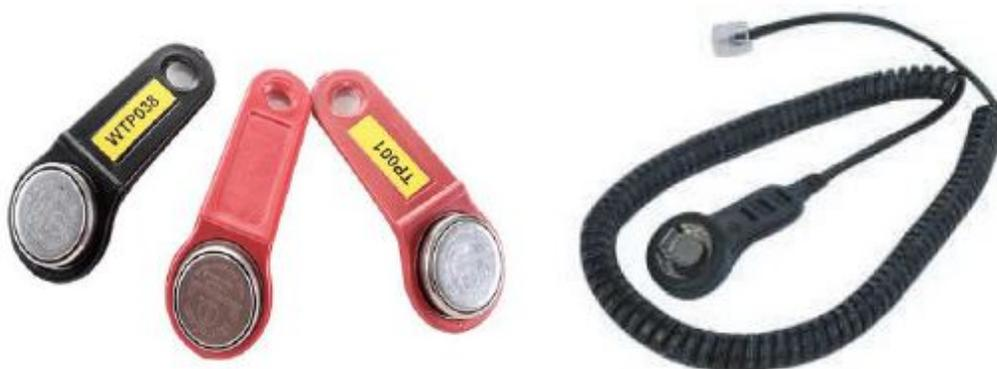
FIGURE 3.5 – Thermopuces et HygroPuces sur porte-clés fixe avec un lecteur thermopuce
