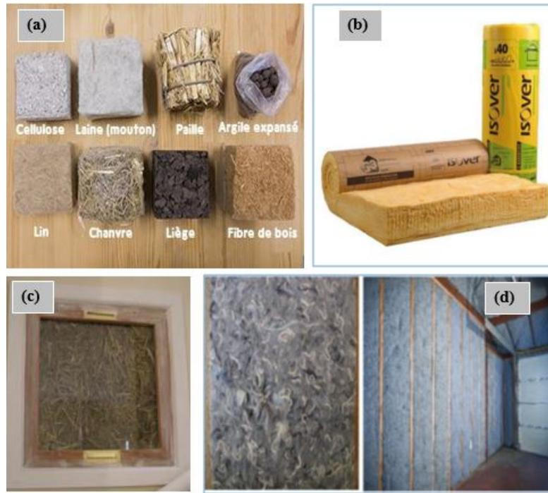
FIGURE 1.8 – (a) :Liste de quelques isolants conventionnels ; (b) :Laine de verre (isolant conventionnels) ; (c) : Balle de paille (isolant non conventionnel) ; (d) : Panneau de réalisé à partir de Cotton recyclé (isolant non conventionnel).
