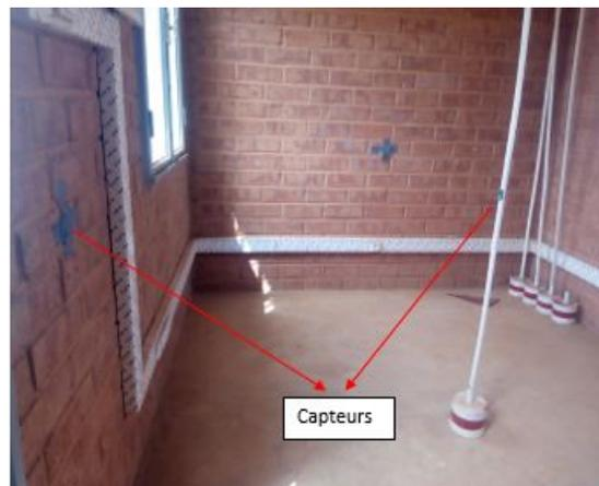
FIGURE 3.4 – Intérieur du bâtiment pilote avec des capteurs mesurant la température
