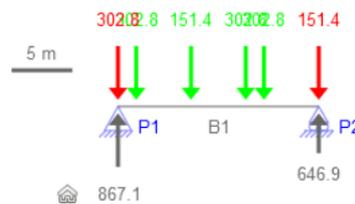
Figure 70 : Chargement du tablier par la surcharge Bc donnant la réaction maximale en kN sur appui
