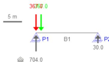
Figure 71 : Chargement du tablier par la surcharge Bt donnant la réaction maximale en kN sur appui
