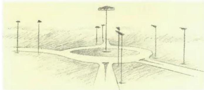
Figure 48: implantation type centrale, vue en perspective (DT588, Eclairage public des carrefours à sens giratoire)
