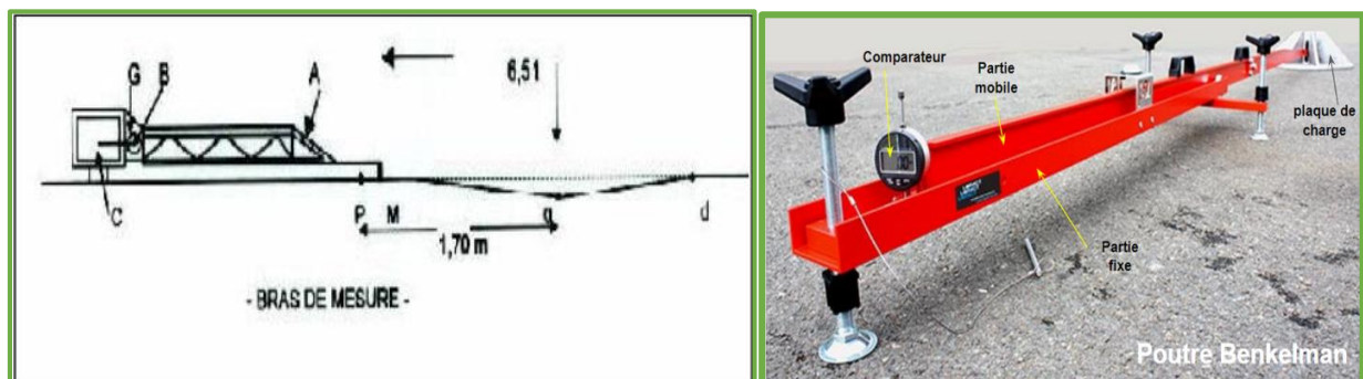
Figure 9 : Bras de mesure de l'appareil de Benkelman
