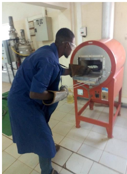
Photo 4: La mise des échantillons dans le four
