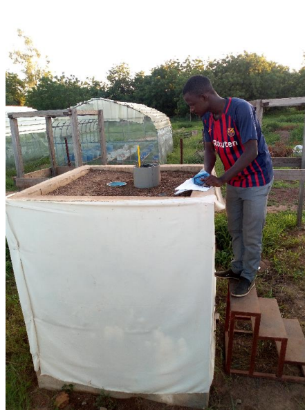
Photo 6: Mesure de la vitesse d'infiltration
