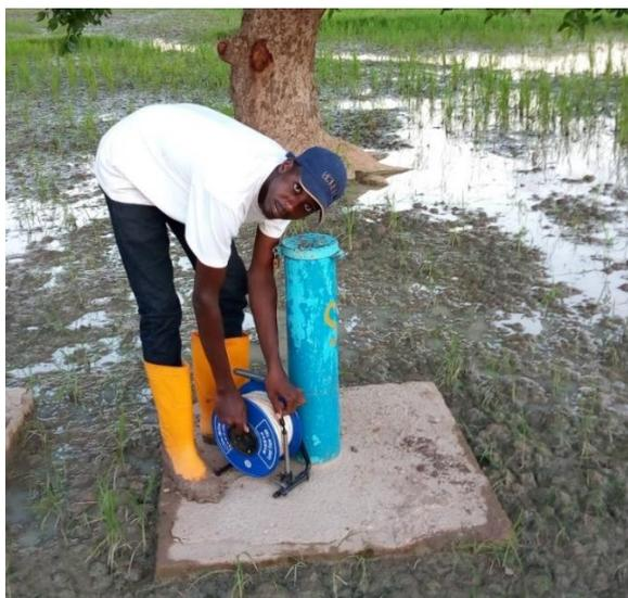
Photos 3: Mesure manuelle niveau du piézométrique
