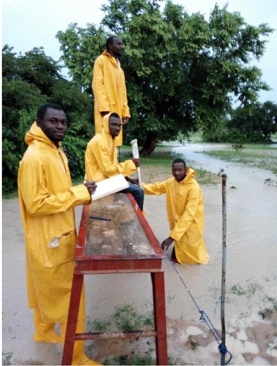
Figure 16 : Mesure du débit du cours d'eau avec le moulinet hydrométrique
