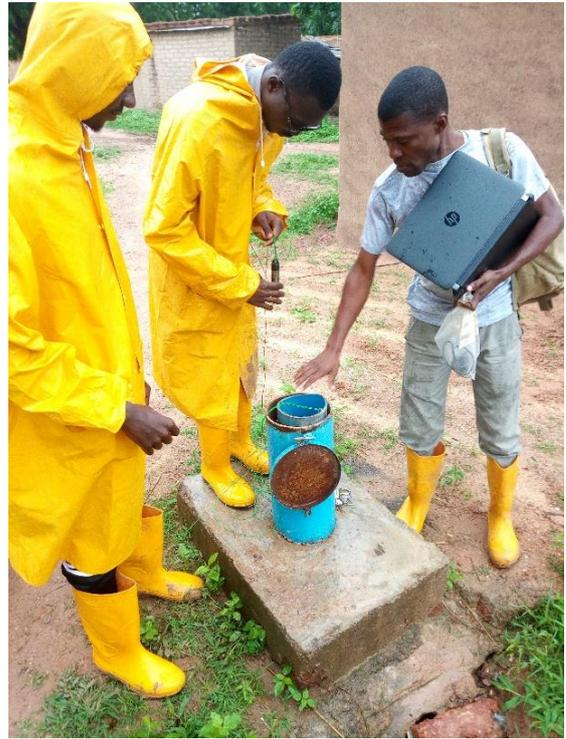
Figure 15 : Collecte données sonde piézométrique
