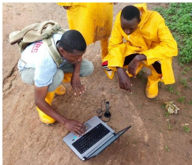
Photos 2: Collecte des données automatiques piézomètre S19
