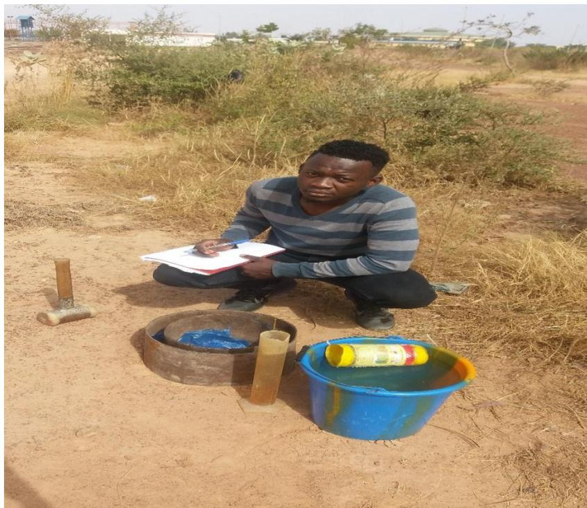
***Figure 9: Mise en place du dispositif de doubles anneaux de Müntz***
