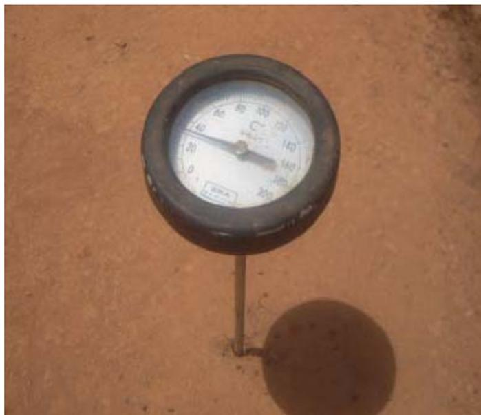
Photo 3-2: Thermomètre à sonde
