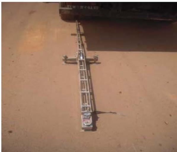
Photo 3-3: Poutre de Benkelman
