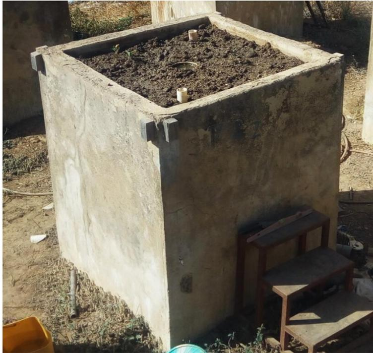
**Planché 2:** Lysimètre contenant du gravier, du sable et du mélange de terre
