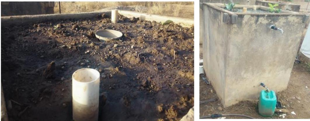
**Planché 4:** Lysimètre constitué de deux (02) Piézomètres ; un entonnoir et raccordé par deux (02) vannes avec un bidon au bas
