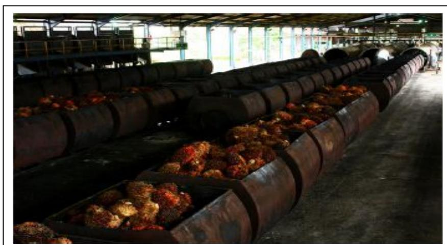
FIGURE\_1 : WAGONNETS DE REGIMES DE PALME POSITIONNES DEVANT DEUX STERILISATEURS [18]
