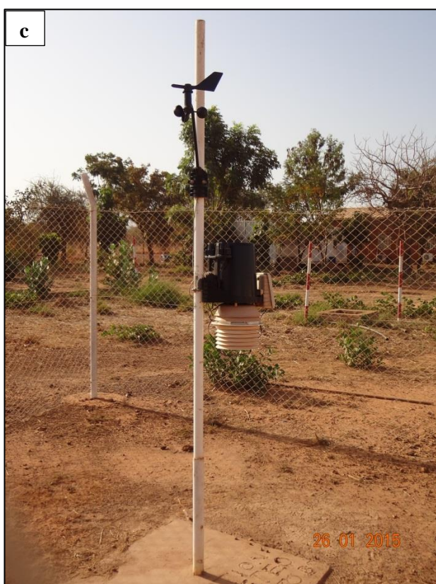
a : Evaporomètre à bac A, Mine Mana (Photo : A. TRAORE) b : Pluviomètre de type "Association", Mine Mana (Photo : A. TRAORE) c : Mini station météo automatique, Mine Mana (Photo : A. TRAORE)
