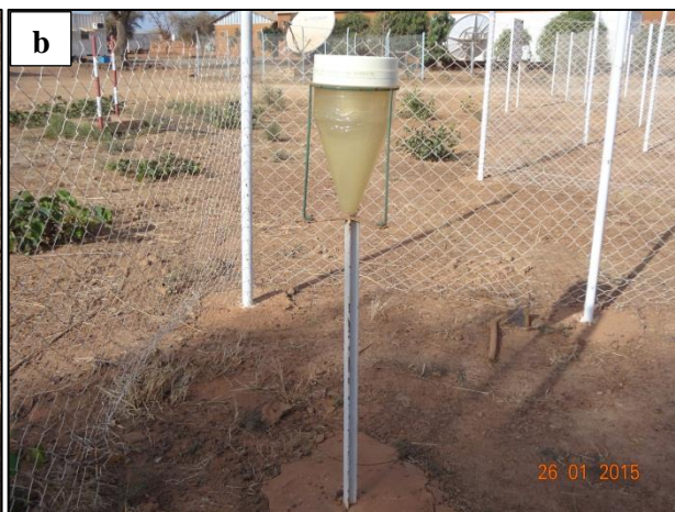
a : Evaporomètre à bac A, Mine Mana (Photo : A. TRAORE) b : Pluviomètre de type "Association", Mine Mana (Photo : A. TRAORE) c : Mini station météo automatique, Mine Mana (Photo : A. TRAORE)
