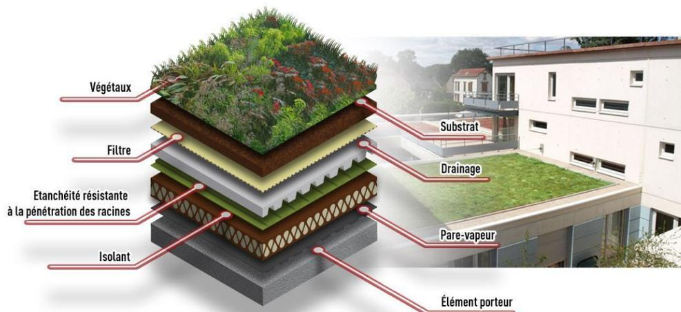
Figure 2: Les différentes couches d'un toit vert (source : [www.batireco.fr](http://www.batireco.fr))
