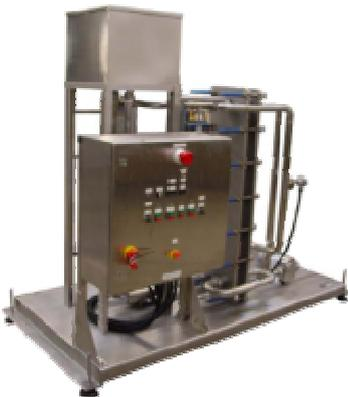
**Matériels : Cuve de clarification munie d'un filtre à plaque avec pompe électrique, filtre à poche**
