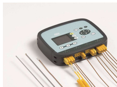
Figure 19: Aperçu du Datalogger HD32.8.16
