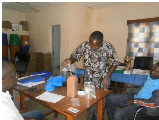
**Prélèvement du chlore pour le watatest**
