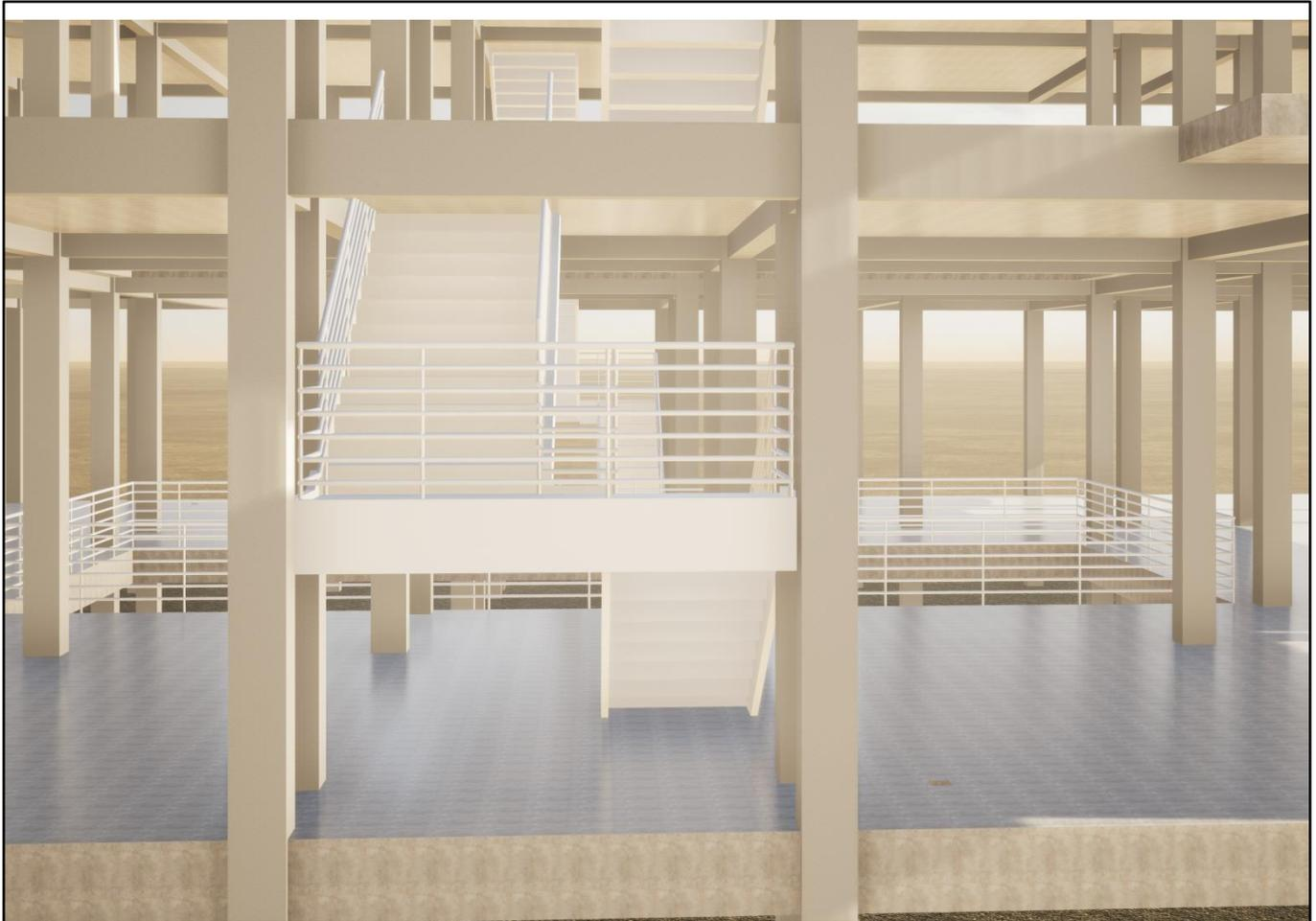
**Figure 8 : Escalier droit à double paliers de l'ouvrage**
