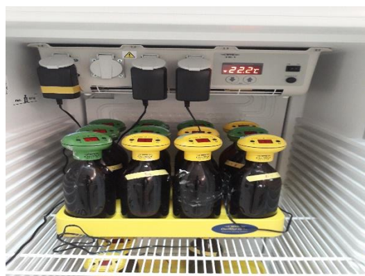
Oxitor placé dans l'armoire thermostatique
