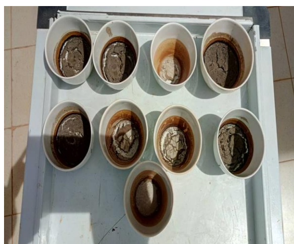
Echantillon après 2H séchage à l'Etuve à 105°C
