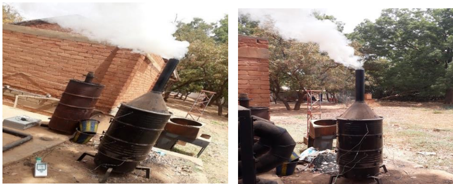
Figure 16 : Production du charbon par pyrolyse lente à 500°C
