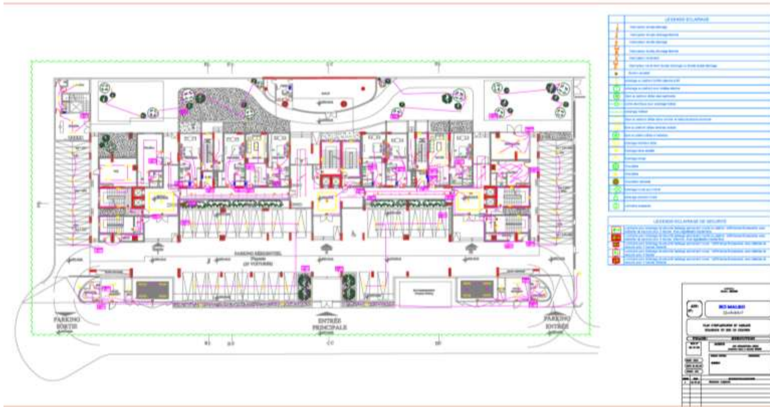
Figure 8.2: Plan d'exécution de l'éclairage au RDC
