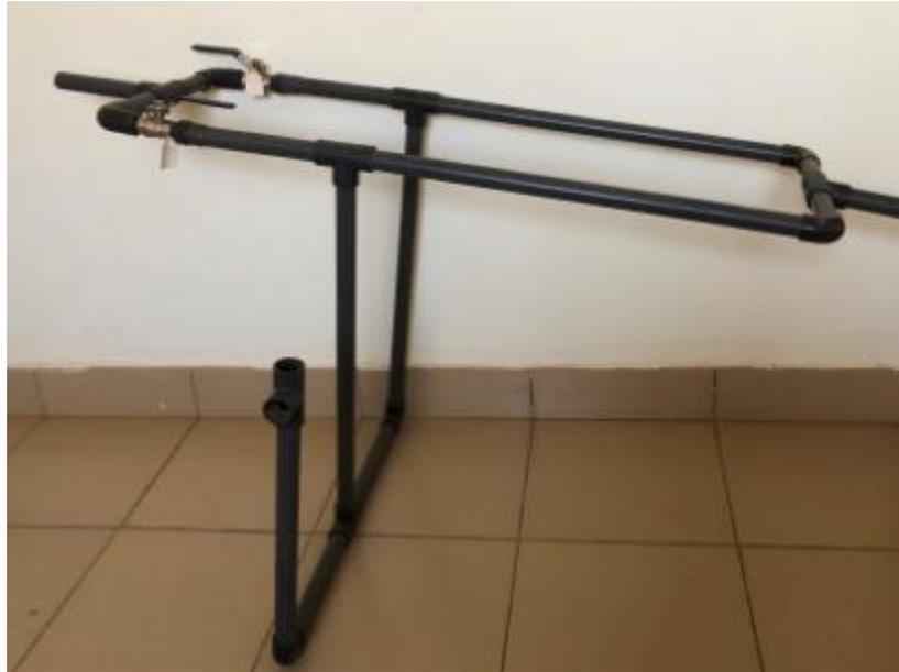
Figure 19 Prototype du système de traitement des vapeurs d'eau du biogaz
