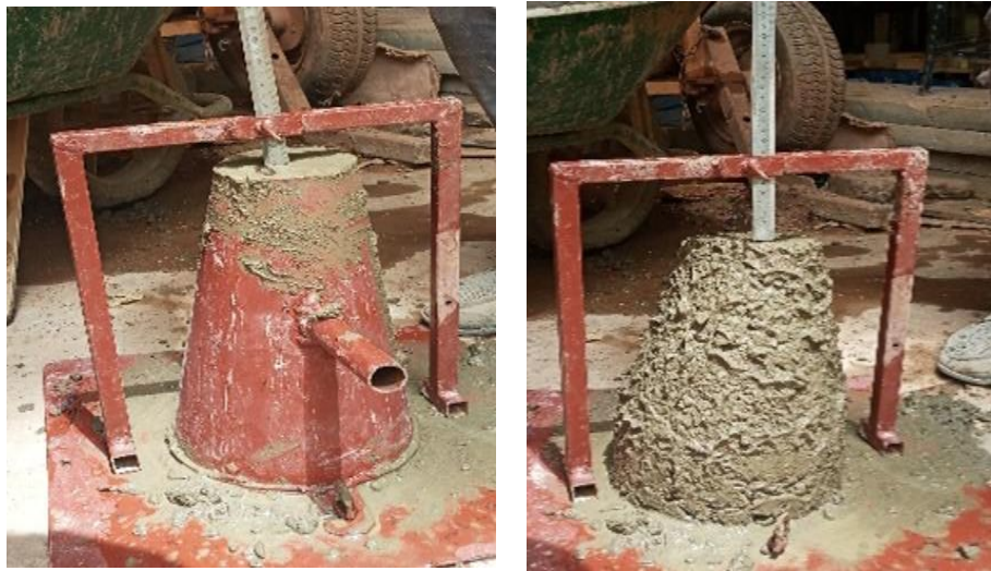
Figure 25 : Affaissement du béton au cône d'Abrams
