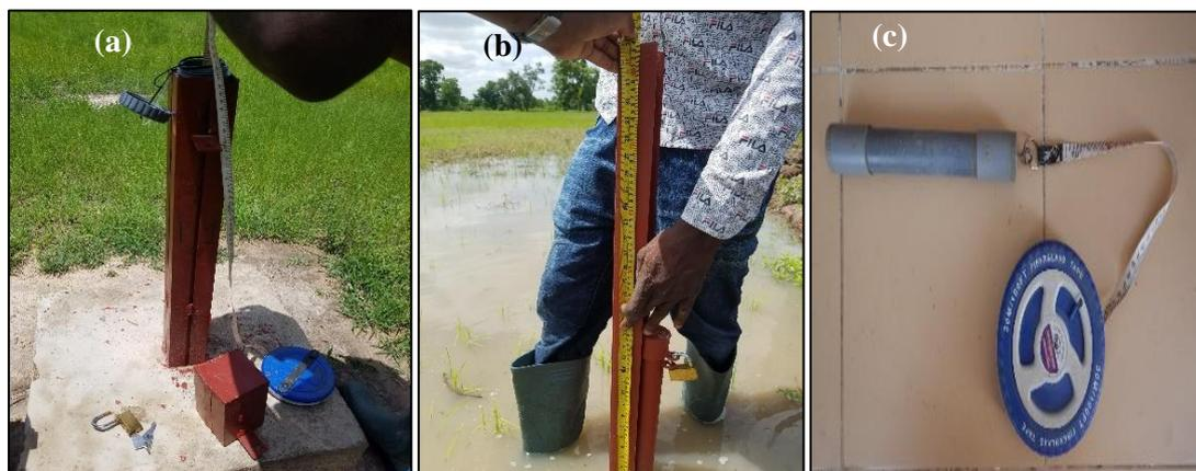
Figure 11 : (a) mesure manuelle du niveau de l'eau au piézomètre 1 ;(b) mesure manuelle du niveau de l'eau au limnimètre 3 ; (c) sonde manuelle
