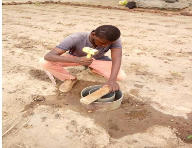
*Figure 15: Mesure D'infiltrométrie de Muntz*
