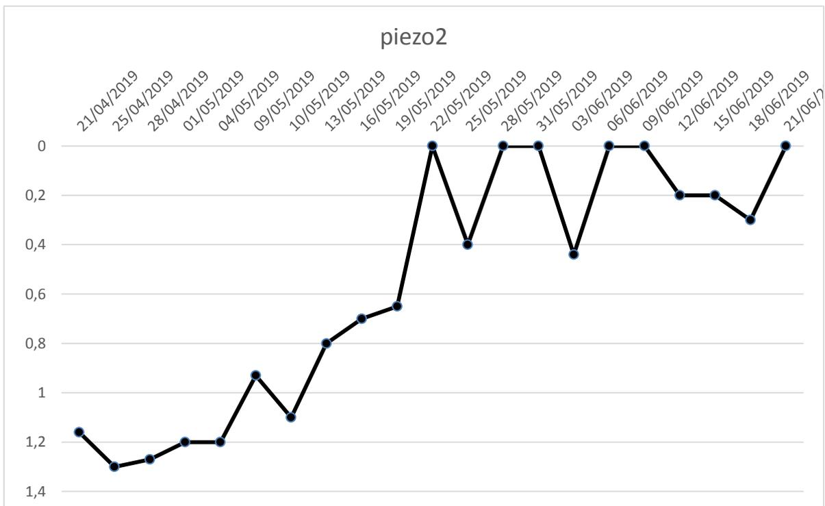
**Figure 15 : Fluctuation de la nappe piézomètre 2**
