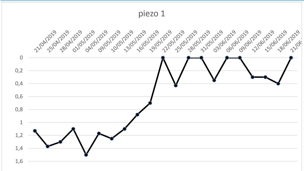
**Figure 14 : Fluctuation de la nappe piézomètre 1**
