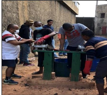
**Figure 9:** Broyage des déchets organiques additionnels par les détenus (Source : J.Jousselin, CICR, 2018)
