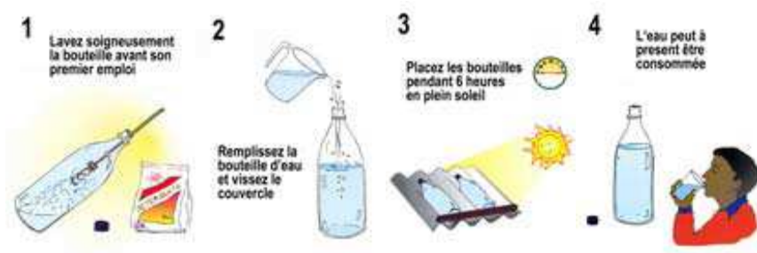
Figure 2: Etape de l'application du SODIS
