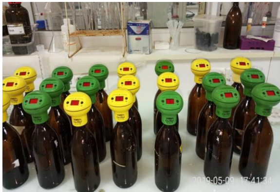
L'Oxitop numérique vissé sur le flacon Oxitop placé dans l'armoire thermostatique
