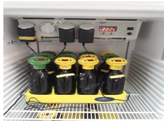
L'Oxitop numérique vissé sur le flacon Oxitop placé dans l'armoire thermostatique
