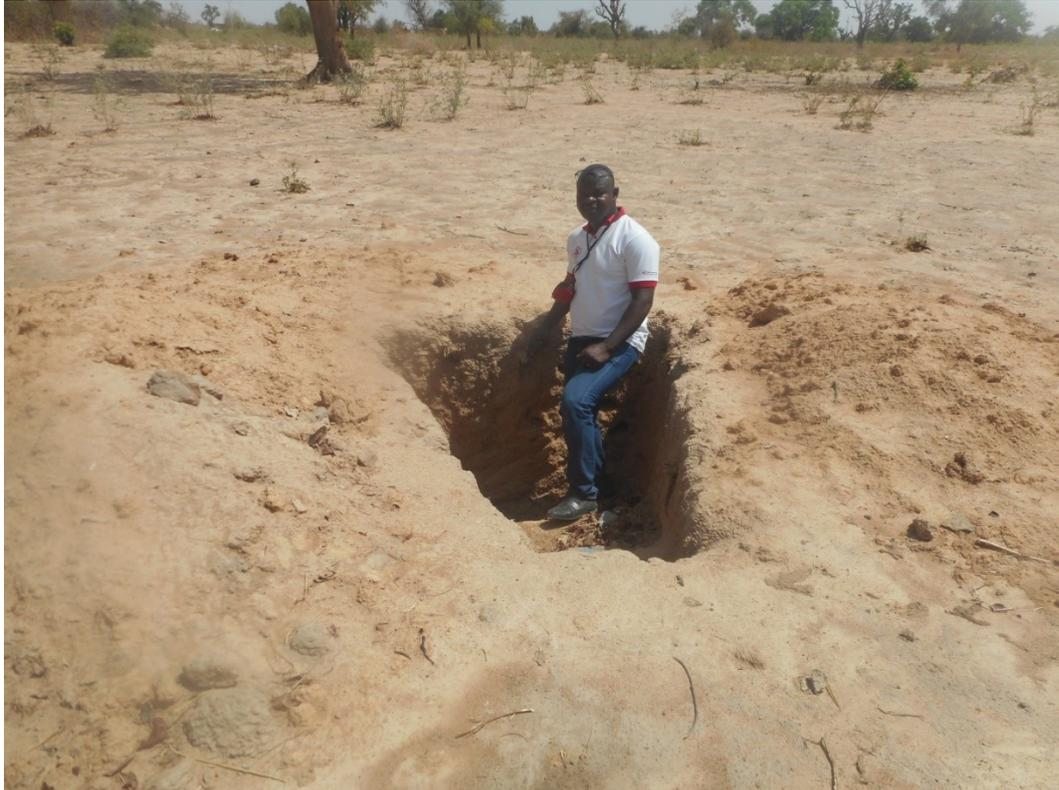
**Figure 2:** Réalisation d'un profil pédologique
