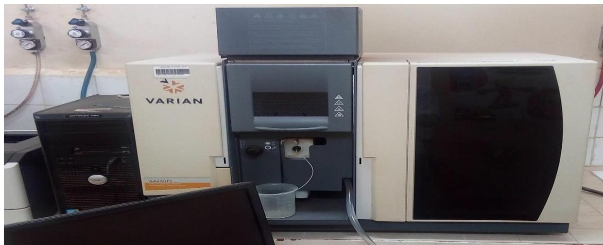
**Figure 9** : Spectrométrie d'absorption atomique à flamme
