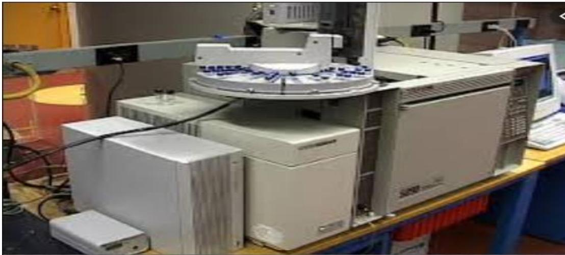
**Figure 7** : Chromatographe GC- MS du LNSP utilisé pour le dosage du BPA
