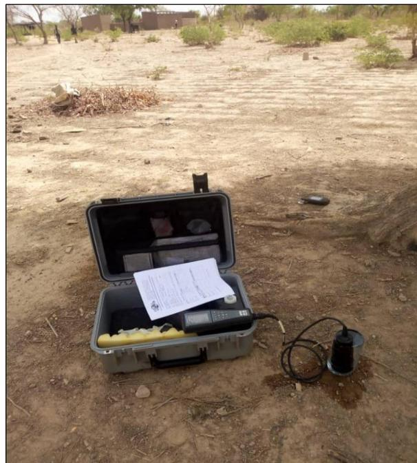
PROFESSIONAL SERIES YSI, pour l'analyse des paramètres de l'eau in situ.
