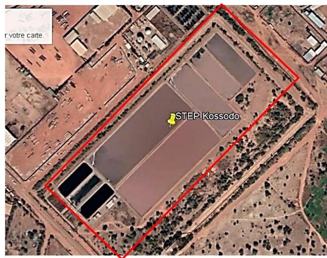
**Figure 5** : Station d'épuration des eaux usées de Kossodo (lagunage à microphytes)
