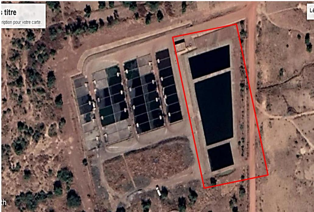
***Figure 8*** : Station de traitement des percolâts de boues de vidange de Zagtouli (lagunage à microphytes)
