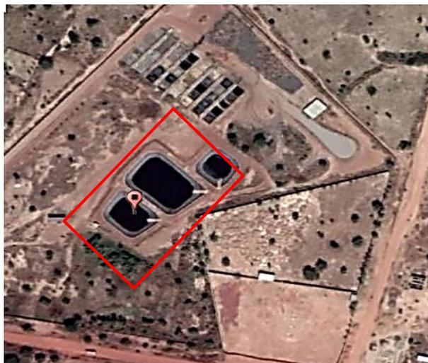
**Figure 6** : Station de traitement des percolâts de boues de vidange de Sourgoubila (lagunage à microphytes)
