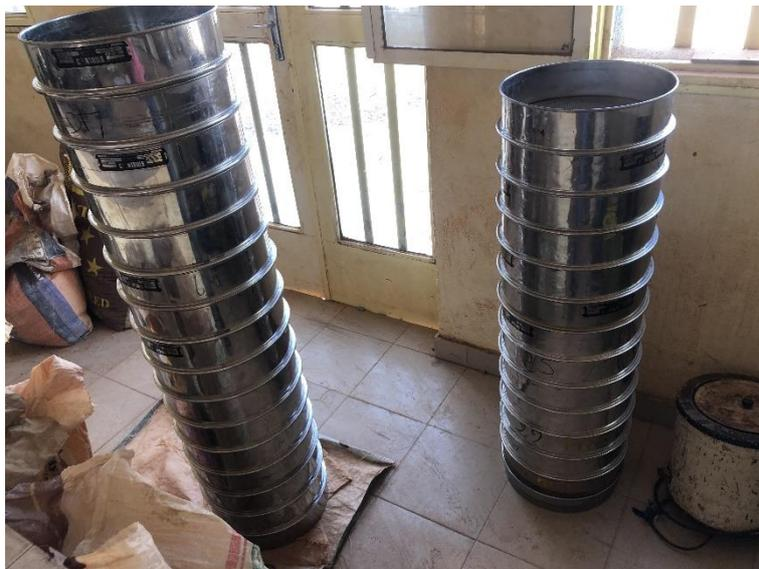
*Figure 11: Tamis utilisés pour l'analyse granulométrique*
