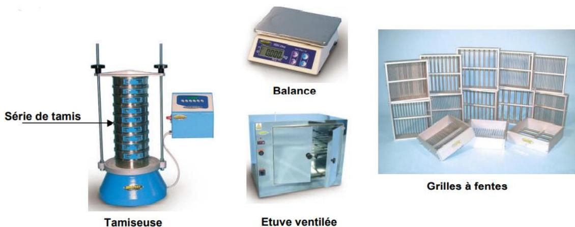
Le coefficient d'aplatissement s'obtient en faisant une double analyse granulométrique, en utilisant successivement, et pour le même échantillon de granulat.
