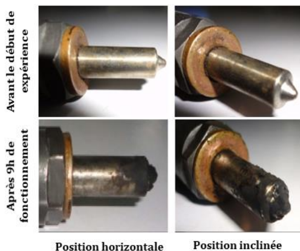
Figure 4 : Formation de dépôt de carbone sur l'injecteur [29]
